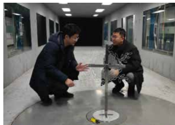
内场“大雪花”1/20 缩尺模型风洞试验
